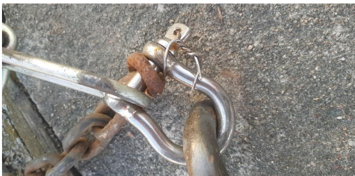
Bild 3. Säkring av schackel mot ofrivillig uppgängning.
